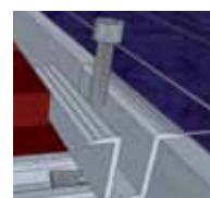
6 Fixation des clamps intermédiaires
