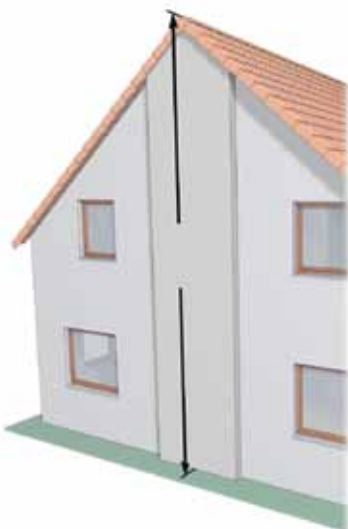
Fig. 1 : Hauteur du bâtiment
